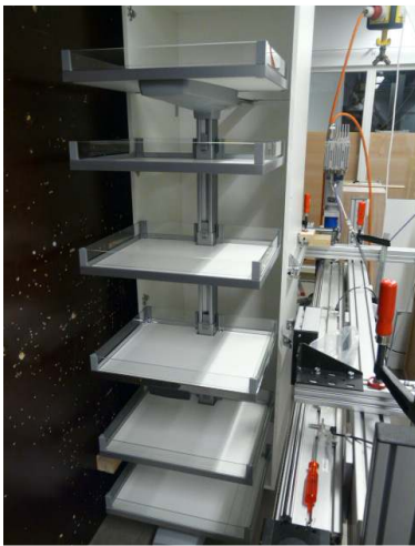
Abb. 3: Obere Führungsschiene am obersten Tablar
