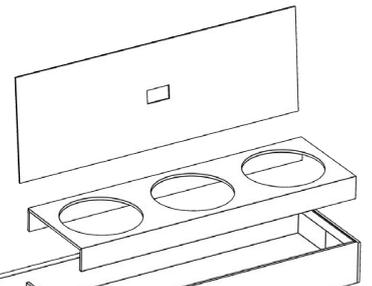
**i** Fijación de la Canal a la superficie mediante adhesivo/velcro **3M**
