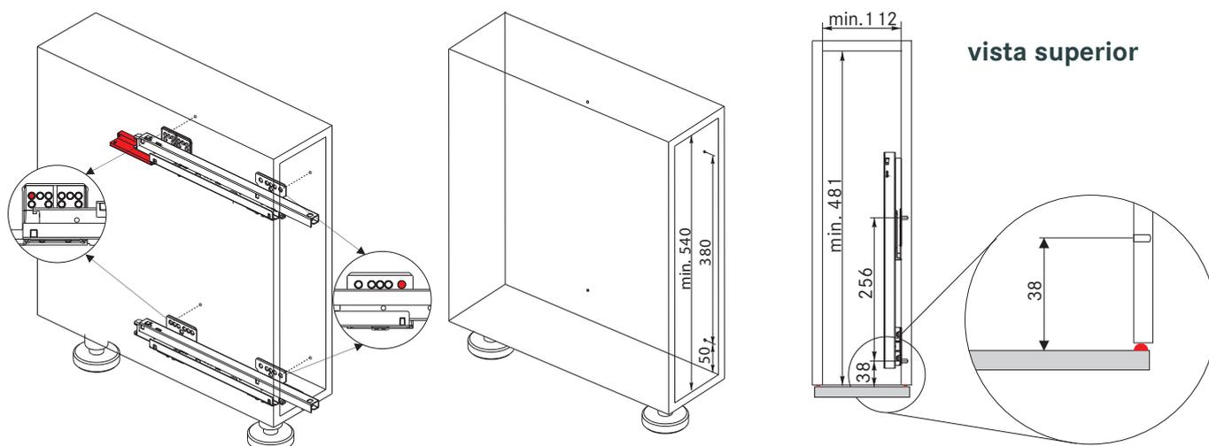
Si no se ha calculado el labio de cierre o el amortiguador de tope, la guía estará demasiado baja en el armario y no podrá enganchar con el herraje.
