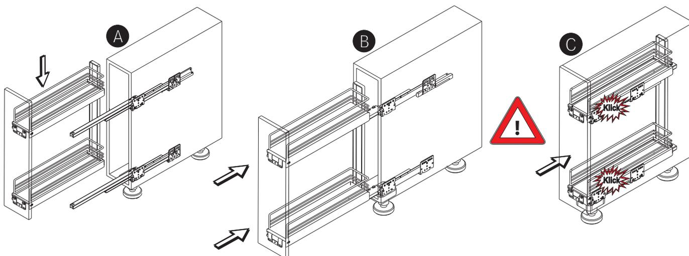
Primero se extraen completamente las guías del armario. En el momento en que el herraje esté completamente presionado en las guías se introduce el herraje en el armario. El herraje está bien encajado cuando suena un „clic“.
