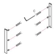
Avvitare i connettori tramite le viti metriche (C) ai due montanti verticali.
