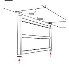
Unire la struttura con le cover fissate ai pensili, utilizzando la vite (D) passante nell'apposito foro. Inserire le cover di chiusura inferiori.
