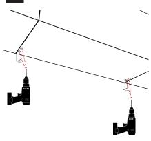
Forare il pensile per poi alloggiare le cover. I fori vanno eseguiti ad una distanza di 7 cm tra il centro della cover e il muro.
