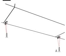
Fissare le cover di ancoraggio al pensile tramite le viti truciolari (A), 2 per ogni cover. Mantenere una distanza di 7 cm dalla parete al centro della cover di ancoraggio.
