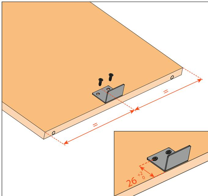
1 B) Fissaggio della squadretta sul ripiano al quale è montato il supporto per il gancio di coda.
