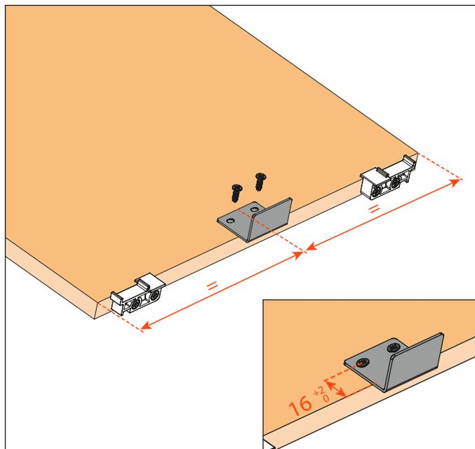
2) Fissaggio del magnete sul fondo.
