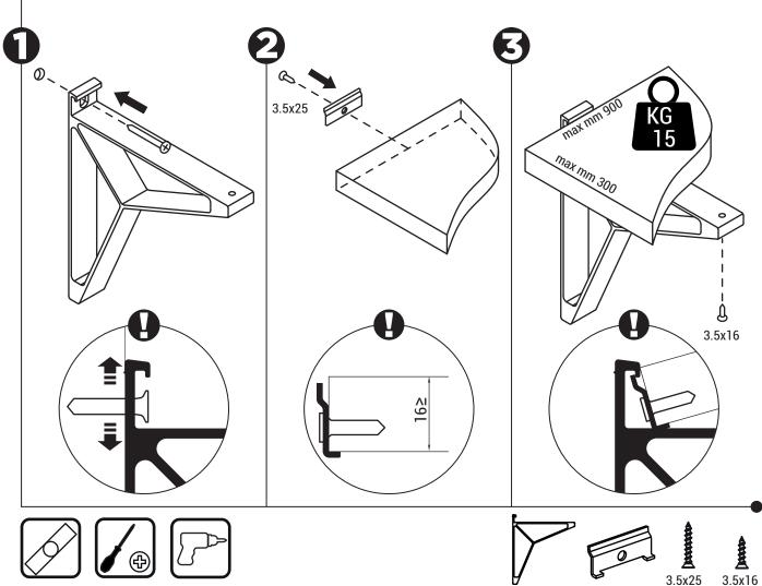
ATENCIÓN: Para evitar el riesgo de vuelco, el objeto debe fijarse firmemente a la pared. Comprueba la solidez de la pared para asegurar la estabilidad del objeto. Un montaje inadecuado puede provocar la caída del objeto y lesiones personales. Utilice tornillos adecuados para el tipo de material de su pared. (no incluido)
