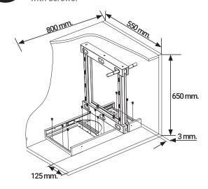
Fijar el bastidor y la base inferior en la base del móculo segun la apertura, derecha o izquierda.
