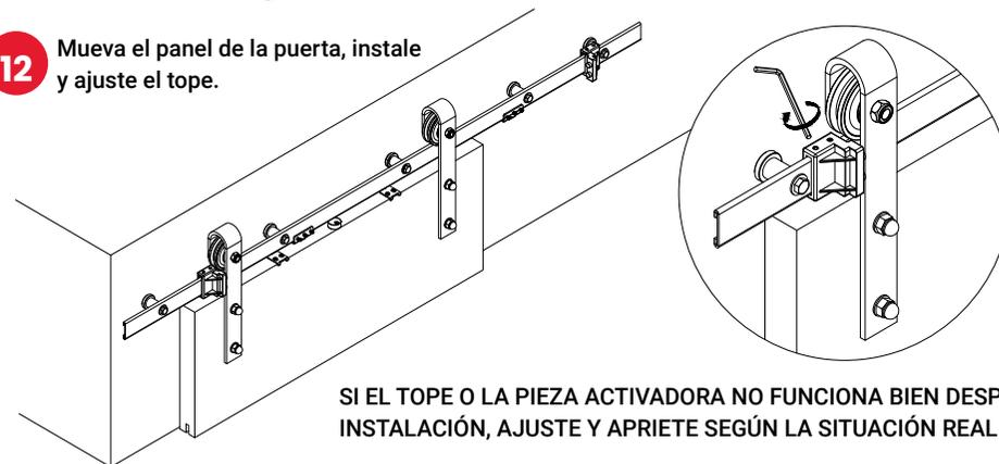
SI EL TOPE O LA PIEZA ACTIVADORA NO FUNCIONA BIEN DESPUÉS DE LA INSTALACIÓN, AJUSTE Y APRIETE SEGÚN LA SITUACIÓN REAL
