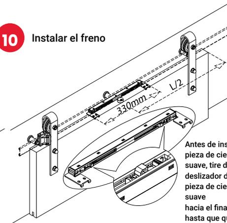
Antes de instalar la pieza de cierre suave, tire del deslizador de la pieza de cierre suave hacia el final hasta que quede bloqueado.
