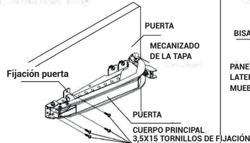
Coloque la placa base de la bisagra plana contra la placa de la puerta, ajuste el tornillo en la posición central.
