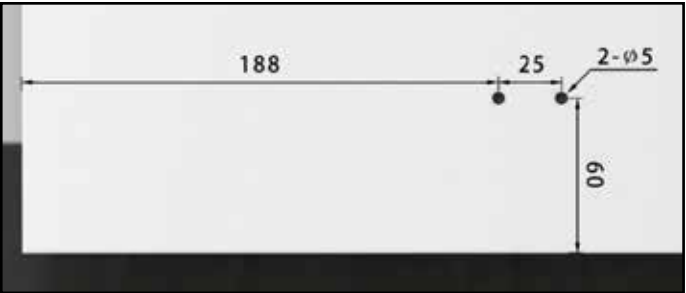
Medida de instalación recomendada para el regulador del tensor (parte superior / parte inferior).
