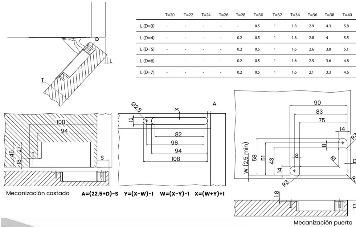
Mecanización costado  $A=(22,5+D)-S$   $Y=(X-W)-1$   $W=(X-Y)-1$   $X=(W+Y)+1$
